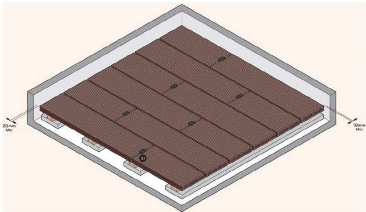
Obr. 7 – pokládka WPC desek s dodržáním dilatačních mezer
