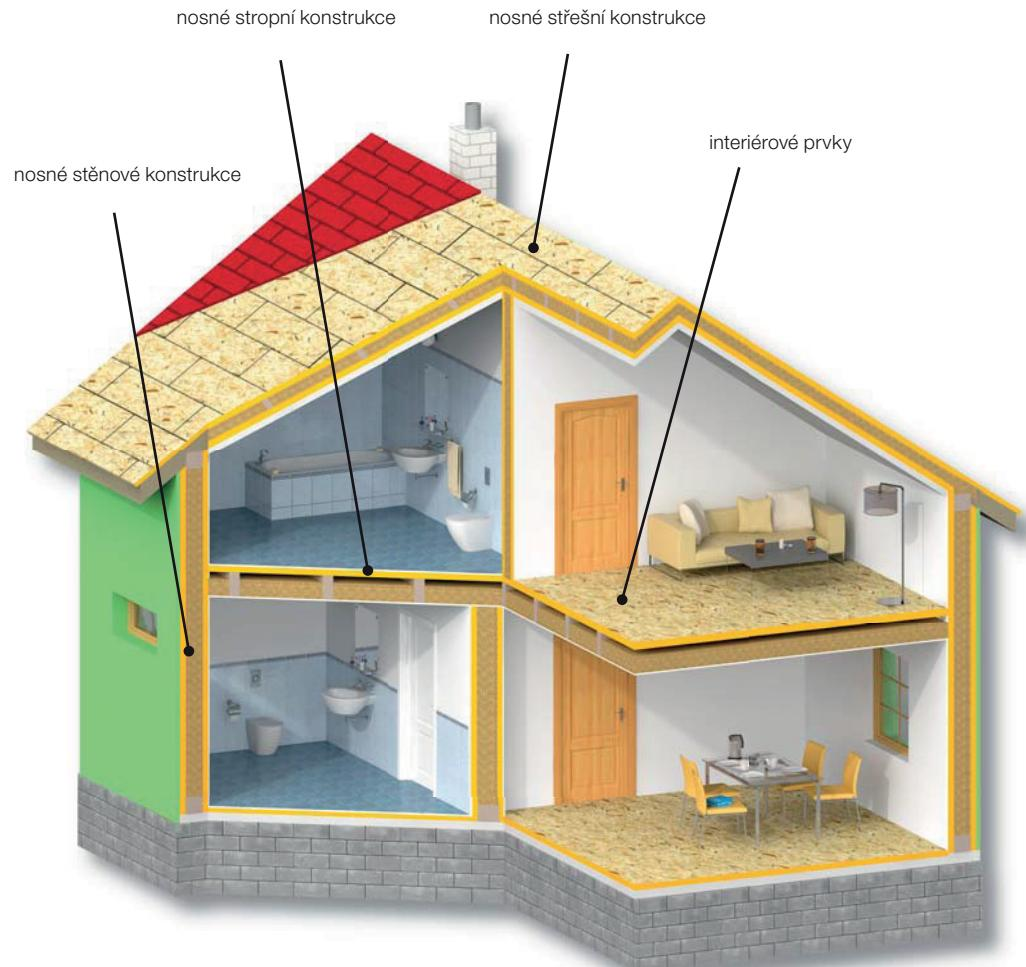
OSB SUPERFINISH® ECO jsou nejprogresivnějším typem OSB desek, které jsou vyvinuty a vyráběny zcela v souladu se současným požadavkem zdravého bydlení zaměřený na ekologické materiály. Vysoké požadavky nejen ekologicky zaměřených staveb splňují desky OSB SUPERFINISH® ECO i ve velmi aktuální oblasti emisí formaldehydu. Pro spojení třísek se používá pojiva zcela bez formaldehydu. Splnění limitů (< 0,03 ppm HCHO komorovou metodou) je doloženo zkušebními protokoly nezávislé instituce (VVÚD).
