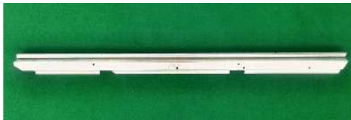
Střešní rohový sloupek levý, pravý s výštipy pozice 8 L + 8 P na obrázku 8 L
