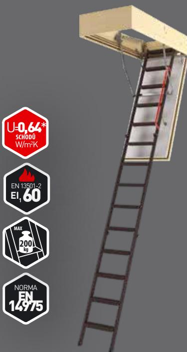
Protipožární půdní schody nové generace **LMF 60** jsou vybaveny kovovým žebříkem. Zaručují vysoký stupeň požární ochrany a také komfortní a bezpečný přístup do půdních prostor. Třída požární odolnosti schodů **LMF 60** je **EI<sub>1</sub>/EI<sub>2</sub>=60 min** (klasifikace dle EN 13501-2), ze strany místnosti, ve které byly instalovány. Jsou dostupné rovněž ve verzi pro vysoké stropy - max. výška 360 cm.
