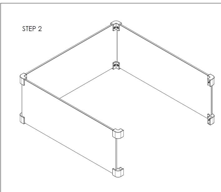
Pak een glasplaatje zonder verbindingen en schuif deze in de glasplaten met verbindingen. Zet het glasplaatje vast met de meegeleverde schroefjes.
