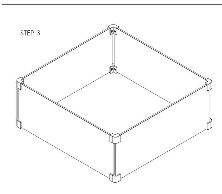
Herhaal stap 2 met het laatste glasplaatje. Controleer of alle schroeven goed aangedraaid zijn en plaats de glasset op uw apparaat.
